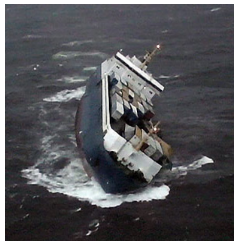
Figur 1. Finnbirch med slagsida efter lastförskjutning orsakad av stabilitetsförlust i följande sjö vilket senare ledde till att fartyget kapsejsade och sjönk. (Foto: Sjöfartsverket).
