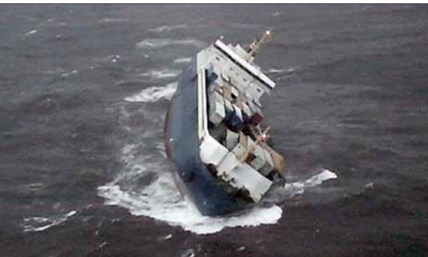
Figur 1: Finnbirch med slagsida efter lastförskjutning orsakad av stabilitetsförlust i följande sjö, vilket senare ledde till att fartyget kapsejsade och sjönk. Foto: Sjöfartsverket
