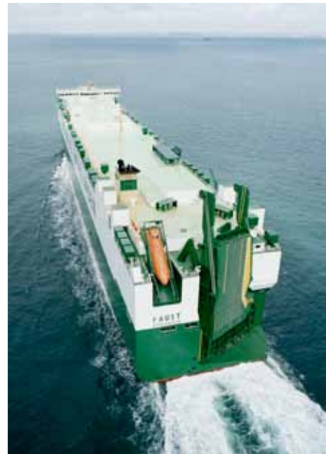
Figur 2 M/V Faust som använts vid utveckling av en metod där fartygets roder och autopilot automatiskt motverkar rullningsrörelsen när parametrisk rullning inträffar. Foto: Fotoflite
