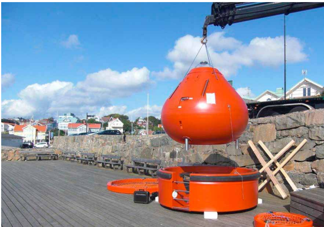
RC 5 losskopplad från sin ballastdel. Se mer på sidan 13. Foto: C. Nordling
