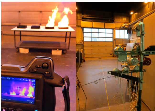
T.v. Flammor från (utbrunnen) methanol med 75% vatten, methanol, etanol samt diesel. (Foto: Franz Evegren) T.h. Sju IR-flamdetektorer monterade för detektionsförsök med methanol på 12 m avstånd.
