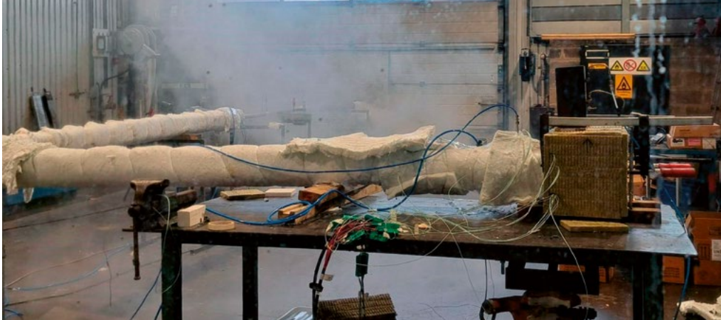
Testbädd där battericellers egenskaper vid termisk rusning undersöks, bla värmeöverföring.
